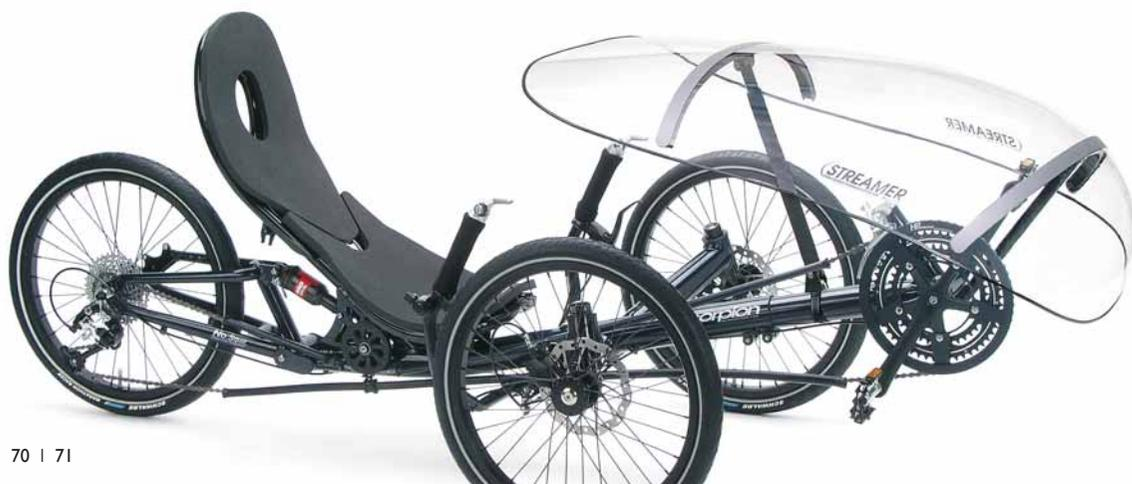
**Schutz vor Wind und Wetter:** Die Frontverkleidung *Streamer* von HP VELOTECHNIK hält Ihre Füße warm und Ihre Beine trocken. Neigung und Höhe sind verstellbar. Der Wetterschutz ist einfach per Schnellspanner abnehmbar und kann zum Transport aufgerollt werden. Tropfenform für geringen Windwiderstand. Gewicht ca. 2,2 kg. Transparenter, robuster Kunststoff.
