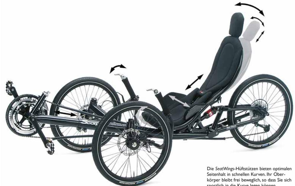
Die *SeatWings*-Hüftstützen bieten optimalen Seitenhalt in schnellen Kurven. Ihr Oberkörper bleibt frei beweglich, so dass Sie sich sportlich in die Kurve legen können.
