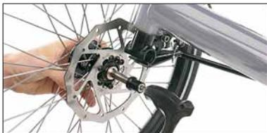
Praktisch beim Transport: HP VELOTECHNIK hat offene Radträger entwickelt, mit denen die Vorderräder mitsamt den Bremsscheiben nach dem Lösen nur einer Schraube einfach abgenommen werden können. (Serienausstattung)
