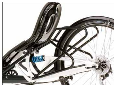
Der stabile Träger für zwei Packtaschen bis 25 kg Last wurde für die hohen Seitenkräfte beim Dreiradfahren optimiert. Ihre Packtaschen hängen schwerpunktgünstig tief unten und nah am Fahrer seitlich neben dem Hinterrad. 14 mm Rohr.
