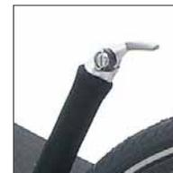
Lenkerendschalthebel liegen optimal in der Hand und ermöglichen schnelles und präzises Schalten. Für die SRAM *DualDrive* Nabens/Kettenschaltung bieten wir auf Wunsch SHIMANO-Lenkerendschalthebel statt Drehgriffschalter zusammen mit einem SHIMANO XT-Schalwerk und einer XT-Kassette mit 11-34 Zähnen als 27-Gang-Option an. Die Entfaltung beträgt 1,50-8,50 m\*.
