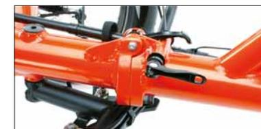
Das robuste patentierte Faltelement von HP VELOTECHNIK rastet beim Auseinanderfallen selbsttätig ein. Der Sicherungshebel wird komfortabel von oben bedient. Spielfreie Edelstahl-Achse für dauerhaft präzises Falten.
