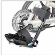
Ergo-Pedal mit Unterschenkelfixierung: Speziell für Nutzer mit Funktionseinschränkungen des Unterschenkels oder Fußes ermöglicht es aktives oder passives Mitführen und Mobilisieren mit jeder Kurbelumdrehung. Winkel, Breite und Höhe der Unterschenkelfixierung verstellbar. Für eine maximale Stabilisierung des Unterschenkels verzichtet diese Variante auf die SPD-Bindung.
