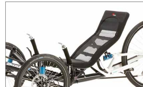
An der wichtigsten Schnittstelle zwischen Mensch und Fahrzeug schaffen die Sitzsysteme von HP VELOTECHNIK eine beispielhaft ergonomische Verbindung. Der luftige ErgoMesh Netzsitz (Abbildung oben) ist in verschiedenen Breiten und Höhen erhältlich, verfügt über eine anatomisch geformte Seitenpolsterung und eine praktische Reißverschlusstasche in der Rückenlehne.
