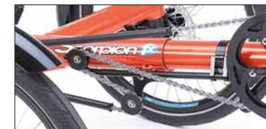
Mit der optionalen Rahmenschnellverstellung kann das Rad rasch auf unterschiedliche Beinlängen eingestellt werden. Durch Einschieben des Tretlagerauslegers wird Ihr Scorpion fx beim Transport damit noch kompakter.
