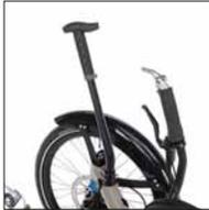
Mit der Aufstehhilfe erhalten Sie zwei Handgriffe, die jeweils links und rechts über den Vorderrädern montiert werden. Diese bieten Ihnen festen Halt, um sich aus dem Sitz hoch zu ziehen oder um sich beim Einsteigen abzustützen. Die Handgriffe können nach dem Lösen einer Schraube einfach eingestellt oder abgenommen werden.
