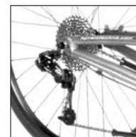
Schaltung SRAM / 30: 30-Gang Kettenschaltung mit zuverlässigem SRAM 10-fach Schaltwerk, Kassette mit 11-36 Zähnen, HP Kettenblattgarnitur mit 40-52-60 Zähnen (20 Zoll Hinterrad) und integriertem Kettenschutzring, 30-42-50 Zähnen (26 Zoll), leicht zu bedienenden Lenkerendschalthebel SRAM 500 SL. Entfaltung 1,67-8,20 m\*. \*Alle Entfaltungen beziehen sich auf 20-Zoll-HR-Modelle
