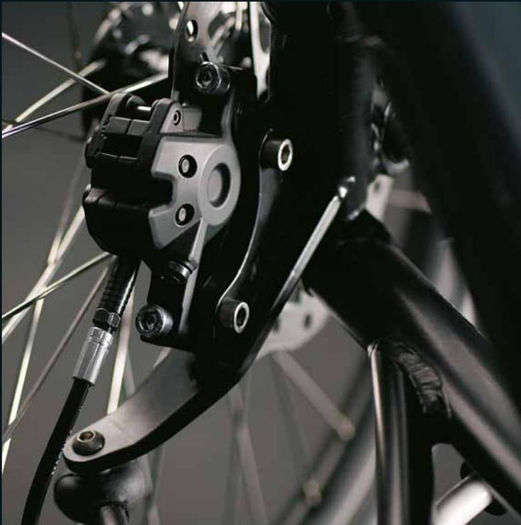
Leichter Aluminium-Radträger mit Aufnahme für Scheibenbremsen. Oberfläche gestrahlt und schwarz matt eloxiert. Dichtungsmanschette über dem äußeren Kugelkopf der Spurstange im Spritzwasserbereich der Räder.
