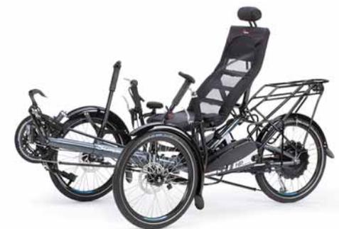
**Rückenwind nach Wunsch:** Auf Wunsch statten wir Ihr *Scorpion fx* mit einem kraftvollen E-Antrieb aus. HP VELOTECHNIKs Zusatzakkuhalterung unter dem Sitz ermöglicht Reichweiten bis 260 km. Mehr zum E-Antrieb auf S. 50.
