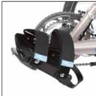
Das Ergo-Sicherheitspedal ermöglicht eine Fixierung und Anpassung an Winkel und Breite des Fußes. Praktische Einhand-Klettverschlüsse mit Federstahl-Einlage. Die SPD-Sicherheitsbindung ermöglicht gelenkschonende Bewegungsfreiheit beim Pedalieren und eine echte Ausstiegsoption in kritischen Situationen.
