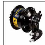
Schaltung ROHLOFF *Speedhub*: 14 gleichmäßig abgestufte Gänge in einer Nabe. Einfach bedienbar mit unserem extra langen Drehgriff. Wartungsarmes, gekapseltes Getriebe im Ölbad. Ketten-spanner und externe Schaltzugbox für einfachen Hinterradausbau. Entfaltung 1,45-7,63 m\*. Die Nabe ist in edlem Schwarz eloxiert.
