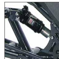
Luftfeder Element *Monarch RL* von ROCK SHOX. Praktisch: Einfach per Pumpe kann die Federhärte an die Zuladung angepasst werden. Mit einer einstellbaren hydraulischen Zugstufendämpfung und blockierbarer Druckstufe ausgestattet, überzeugt es mit hervorragendem Ansprechverhalten in unseren Tests. 262 g Gewichtsersparnis gegenüber dem Stahlfeder Element DNM-22.
