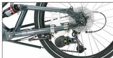
Die von WEBER und HP VELOTECHNIK entwickelte Anhängerkupplung für den *Scorpion* ist mit einer soliden Befestigungsplatte ausgestattet, durch die der Kupplungspunkt um 5 cm nach unten verlegt wird. So kann der Gepäckträger komplett einfedern, ohne die Anhängerdeichsel zu berühren. Tipp: Für CHARIOT Anhänger ist eine abgesenkte Deichsel für 20"-Fahrräder erhältlich.
