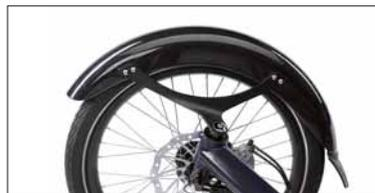
**Funktionale Schutzbleche:** Die *Trikefender* von HP VELOTECHNIK bieten einen sehr guten Spritzschutz nach hinten und besonders seitlich zum Fahrer. Die Innenseite der aus robustem Kunststoff gefertigten Rad-schützer ist weit heruntergezogen. Elegante, innen liegende Befestigung mit Höhenverstellung für Reifen bis 50 mm.
