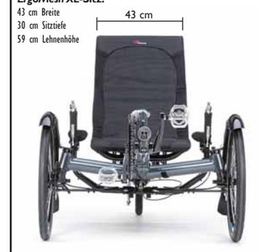
**Verändern Sie öfter Ihr Niveau!** Die orthopädisch überzeugenden Sitzsysteme von HP VELOTECHNIK sind per Schnellspannbefestigung in 15 Sekunden abnehmbar und damit im Handumdrehen untereinander austauschbar.
