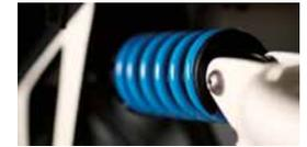
**Das Herzstück:** Federelement für die Hinterradschwinge mit hydraulischer Dämpfung. Durch Verdrehen der Feder können Sie ohne Werkzeug die Feder Vorspannung fein einstellen, um das Fahrwerk an Ihre Zuladung anzupassen. Für die grundlegende Anpassung an das Fahrergewicht stehen verschiedene, einfach austauschbare Stahlfedern zur Verfügung.
