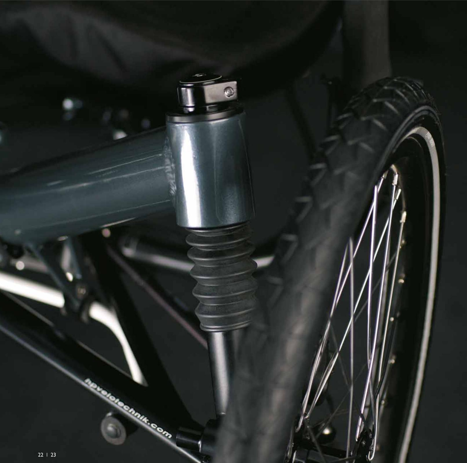
**Die Federbeine** werden mit elastischen Domlagern im Rahmen abgestützt und bleiben dadurch stets frei von Querkräften. Ihr spürbarer Vorteil: Das beeindruckend sensible Ansprechverhalten und verwöhnender Federkomfort auch im hochfrequenten Bereich.
