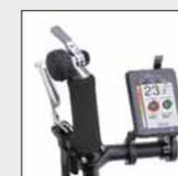
Die „Top View“-Halterung am oberen Ende des Lenkers rückt die Anzeige des GO SWISSDRIVE-Systems näher ins Gesichtsfeld, verkleinert aber etwa in Kombination mit einer Aufstiehilfe den Platz. Bei Einhandbedienung mit links montiertem Display wird die Faltfunktion eingeschränkt.
